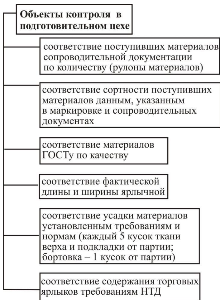
Рис. 4.1. Объекты контроля в подготовительном цехе
