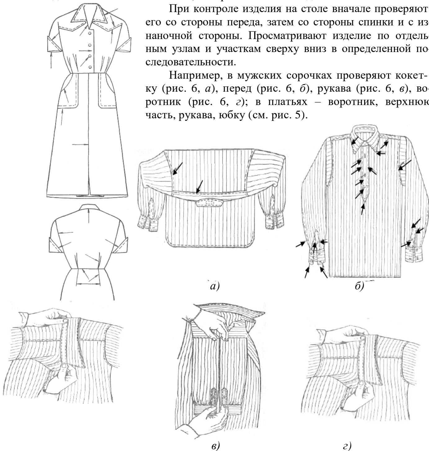
Рис. 6. Контроль качества мужской сорочки а – кокетки; б – переда; в – рукавов; г – воротника
