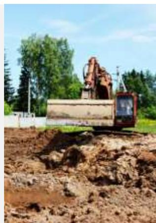
Планировочный поворотный ковш 2000 мм, 0,85 м<sup>3</sup> на экскаватор КРАНЭКС
