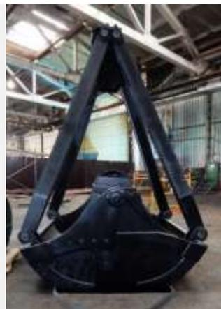
Грейферный двухчелюстной ковш объёмом 2,3 м<sup>3</sup> для плавучего крана
