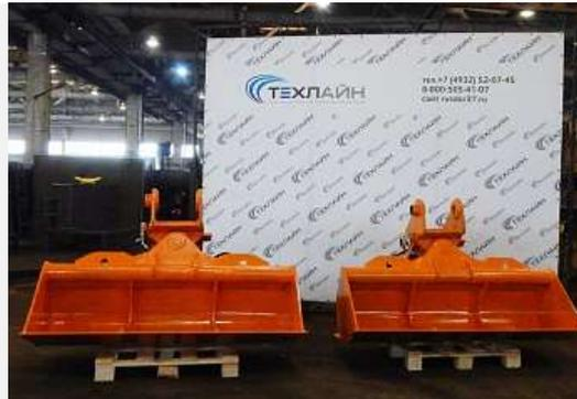
Планировочные гидроповоротные ковши на экскаватор Hitachi ZX 200, шириной 2000 мм
