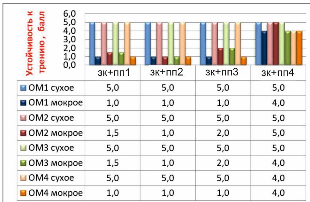
Рис. 6. Устойчивость покрытия к сухому и мокрому трению
