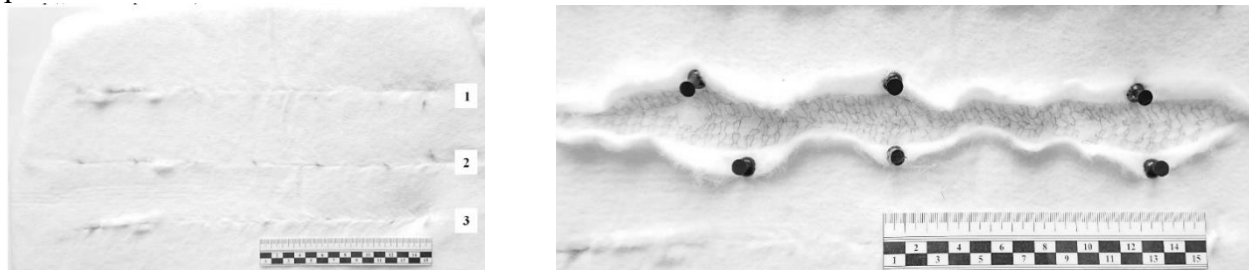
Рис. 5. Состояние образца после проведения испытаний с раскрытием разреза
