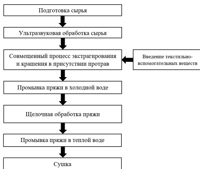
Рис.1. Технология совмещенного способа крашения шерстяной пряжи природными красителями с использованием биопротрав
