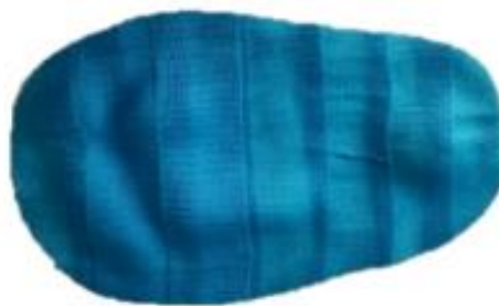
Рис. 3. Образец прокладки из слоев полимерного бинта в доньшко реабилитационного чехла для ног
