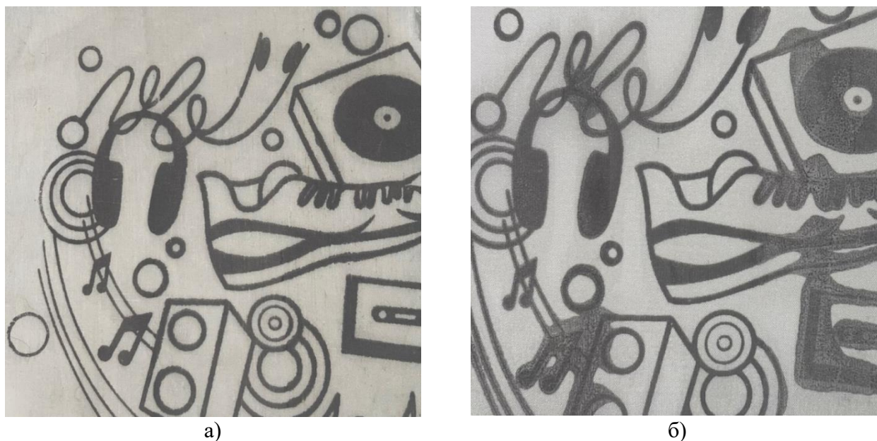
Рис. 2. Печать термохромным красителем марки «ТН30 Thermochrome Black 28 ^{\circ}\text{C} » на текстильных материалах: а) – хлопчатобумажная ткань, б) – полиэфирная ткань
