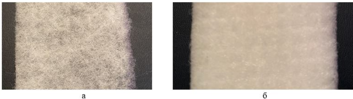
Рис. 4. Фильтрующие нетканые материалы «Холлофайбер»: а – волокнистая поверхность; б – оплавленная (каландрированная) поверхность
