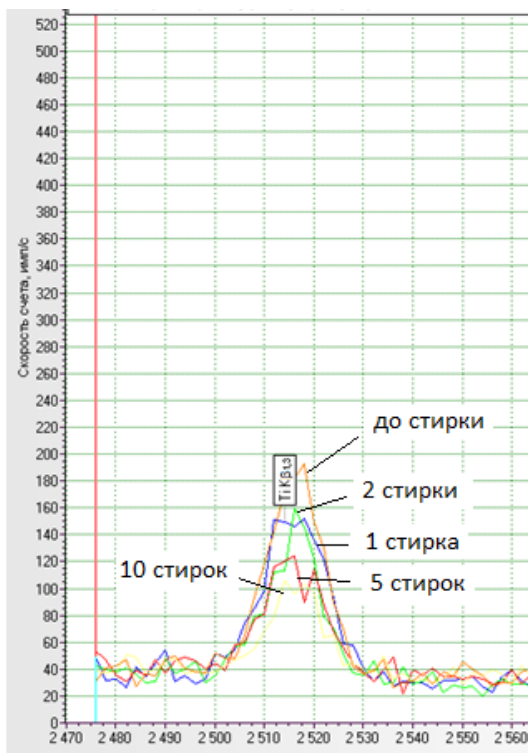
Рис. 2. Зависимость содержания Ti на поверхности шерстяной ткани от количества стирок
