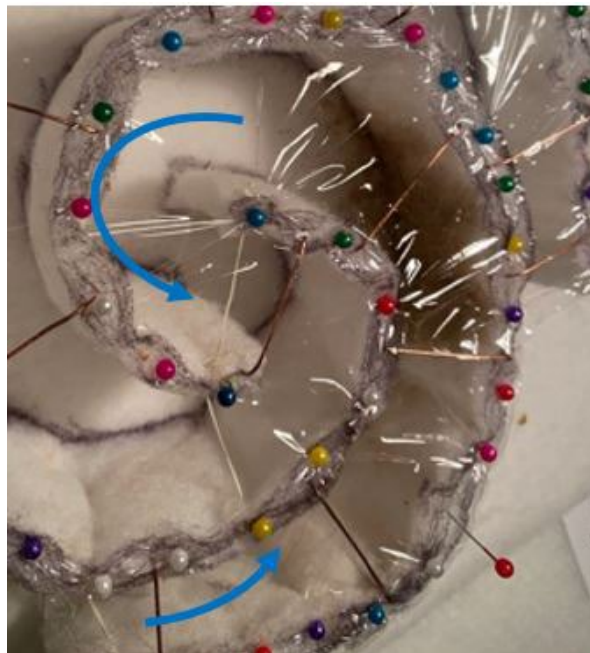
Рис. 7. Осевшие на фильтровальном материале частицы льняной пыли (стрелками показано направление движения воздушного потока)
