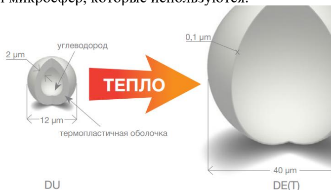
Рис. 2. Модель увеличения объема полимерных расширенных микросфер Expancel
