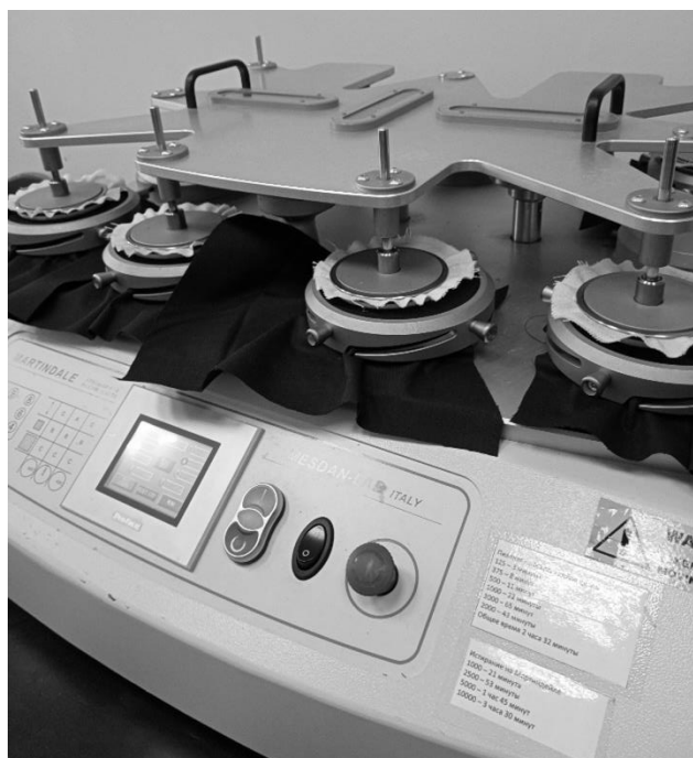
Рис. 3. Истирание образцов по методу Мартиндейла
