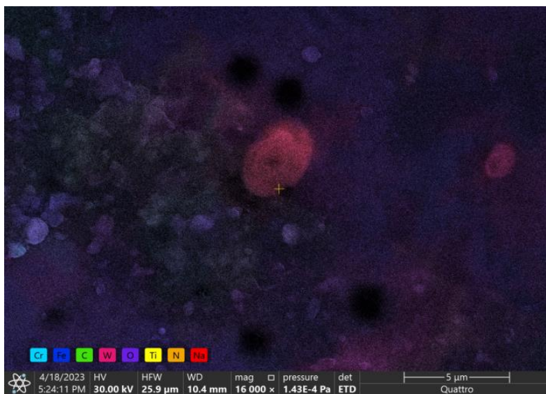
Рис. 1. Микроструктура поверхности кромки режущего инструмента, увеличение x16000
