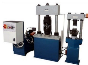
Разрывная машина ИР-100М производства компании «Метротест» с программным обеспечением «М-Test» (г. Нефтекамск)
