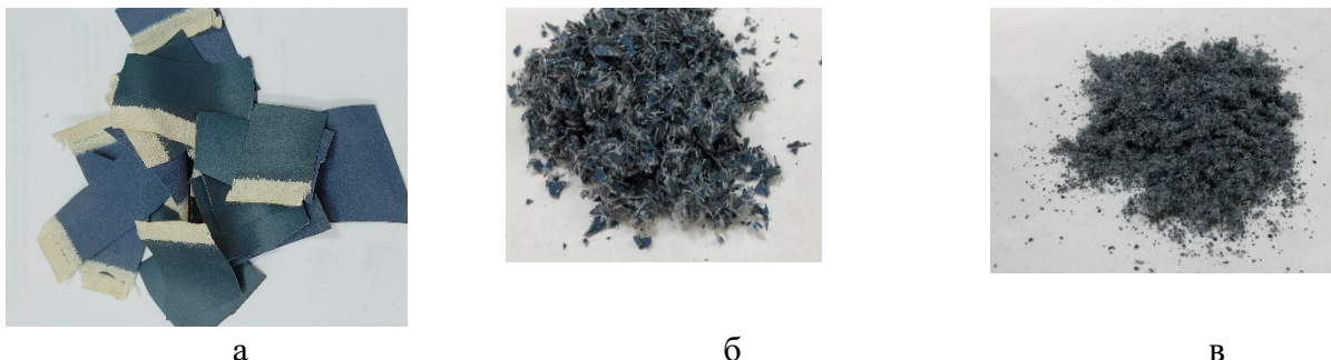
Рис. 1. Вид отходов многослойного прорезиненного материала: а – отходы, подготовленные к измельчению; б - измельченные отходы (размер решетки 5 мм); в – измельченные отходы (размер решетки 2 мм)
