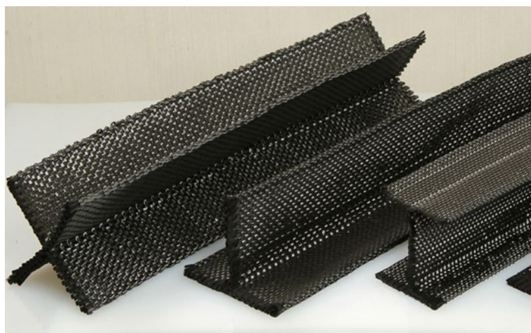
Рис. 2. Элементы конструкций, выполненные методами 3D ткачества
