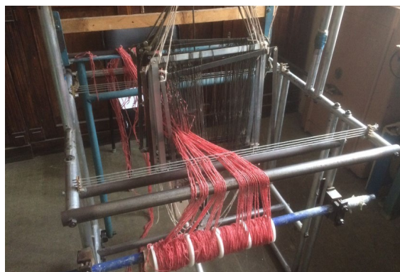
Рис. 2 Система питания нитями основы ручного ткацкого станка
