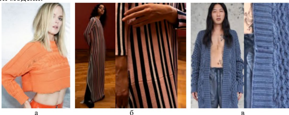
Рис. 1. Влияние параметров оборудования на форму изделия: а) поперечное вязание; б) поперечное вязание, шов из-за ограничений в ширине полотна; в) шов из-за ограничений ширины полотна
