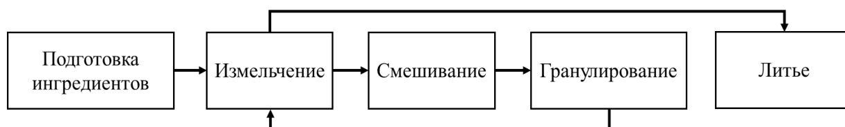
Рис. 1. Этапы технологии получения материалов на основе вторичного ППУ
