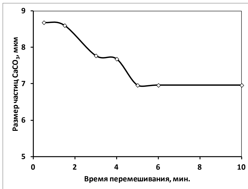
Рис.3. Изменение размерных характеристик частиц CaCO 3 в зависимости от времени перемешивания.
