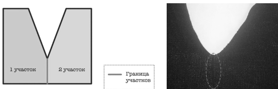
Рис.3. Схема расположения участков вязания при вязании интарсией (слева), выработанный образец (справа)
