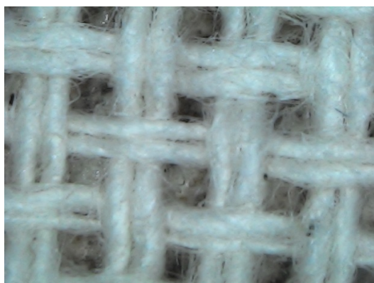
а) б) Рис.1. Микрофотографии структуры ткани: а) рогожка; б) бязь – стандарт
