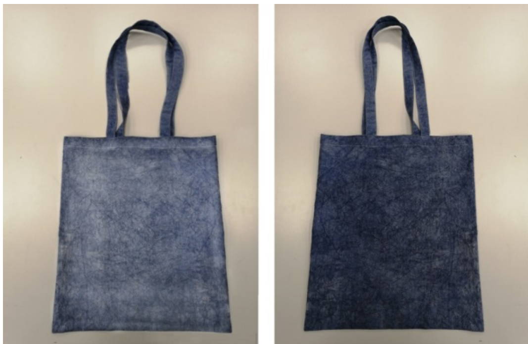
Рис. 5. Сумки-шопперы, изготовленные из суровой хлопчатобумажной ткани, окрашенной двумя различными способами красителем кубовым синим Д.
