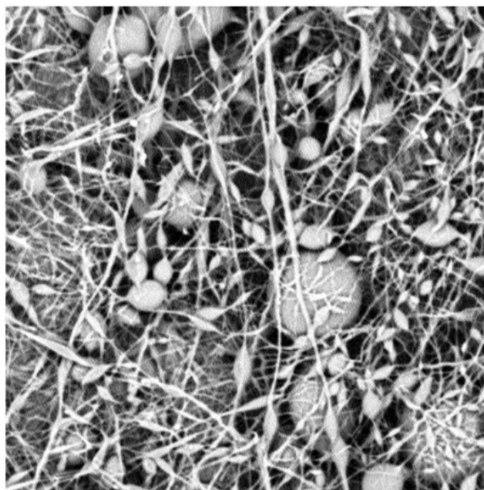
Рис. 2. Микрофотографии волокон, полученных по методу Nanospider™ из формовочной композиции ПЭУ:(ПАК:ПВС)=3:1 (увеличение в 5000 раз)
