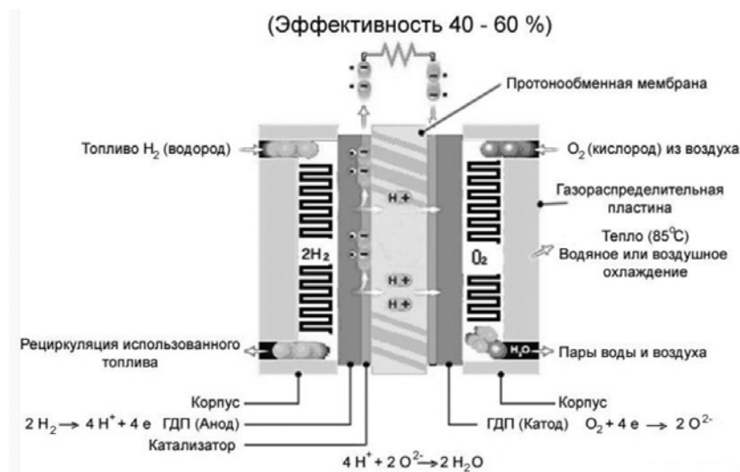
Рис. 1 Схема топливного элемента, в котором в качестве электролита используется полимерная протонообменная мембрана
