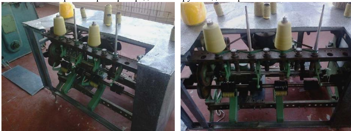
Рис.1. Устройство для кручения пряжи
