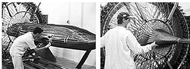
Рис. 3 Применение 2.5 плетения при изготовлении фюзеляжа ракет (компания Fiber Innovations)
