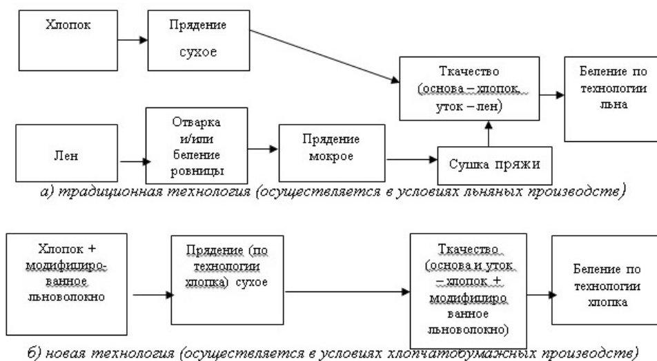
Рис.2. Технологические схемы производства льносодержащих тканей
