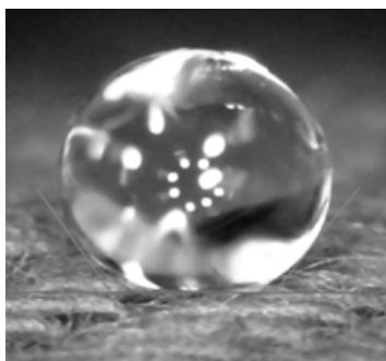
Рис.2. Капля воды на поверхности обработанной ткани (ПЭГ (10 000) 5 г/л; 2,4-ТДИ 6 мл/л; температура термообработки -180^{\circ}\text{C} )
