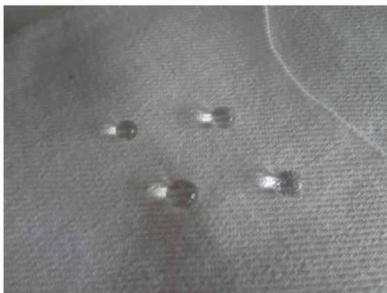
Рисунок 2. Капли воды на поверхности хлопчатобумажной ткани, обработанной ПЭГ (6000) и 2,4-ТДИ
