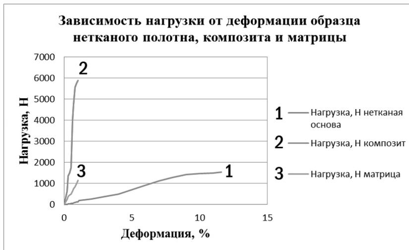
Рис 1. Диаграмма разрушения при растяжении нетканого полотна, материала связующего и композиционного материала.
