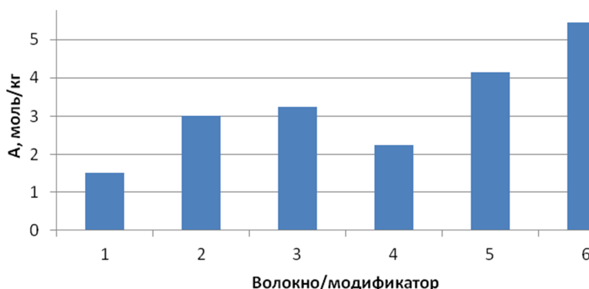
Рис.3. Диаграмма сорбционной емкости льноволокна в зависимости от способа котонизации и модификации (начальная концентрация метиленовый синий в растворе 1г/л): 1-короткое льняное волокно, 2- короткое льняное волокно, модифицированное капролактамом, 3- то же модификация полидоном, 4- котонин, 5- котонин модифицированный капролактамом, 6 - котонин модифицированный полидоном.
