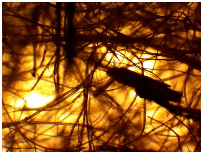
Рисунок 4 – Структура смесовой композиции волокон «Холлофайбер ПАФС» - 25% и короткого льняного волокна - 75% с увеличением  $\times 40$ .
