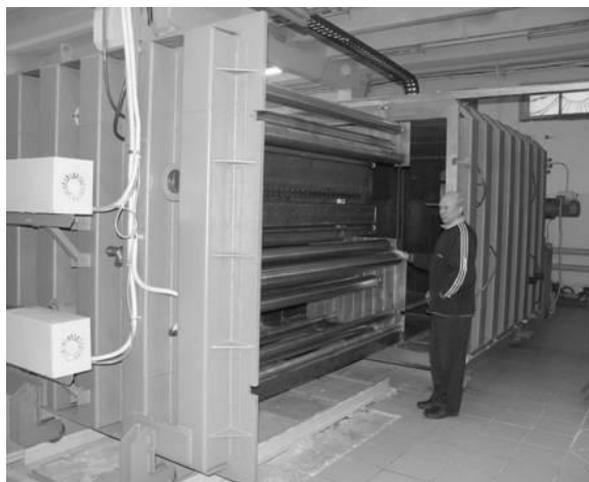
Рис. 2. Фотографии установок УМН-180 и ММ-180 для нанесения покрытий на ткани и полимерные пленочные материалы
