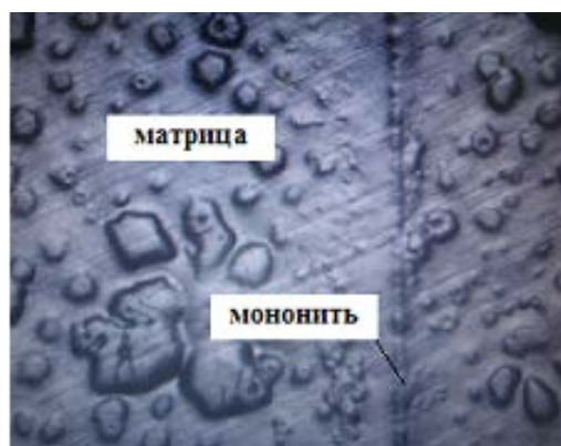
Рис 6. Расположение мононити в матрице.
