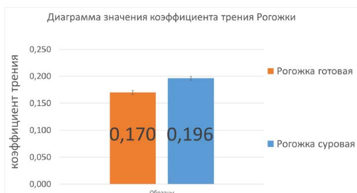
Рис. 3. Численные значения коэффициента трения между стальным проводником и полотном готовой тканой структуры рогожка
