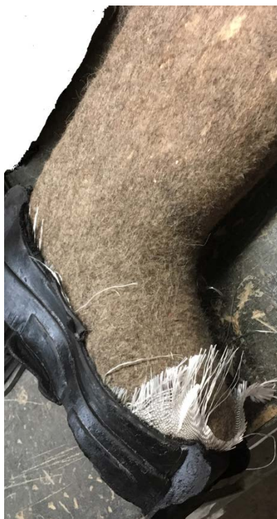
Рис. 1. Модель (полуфабрикат) войлочной обуви с использованием антипрокольного слоя
