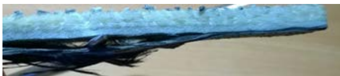
Рис.2. Фотография разрушения образцов многослойного композиционного материала
