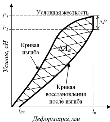
Рис. 4. Диаграмма изгиба и восстановления после изгиба
