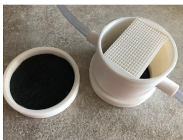
Рис. 1. Волокнисто-пористый фильтрующий материал с повышенными фильтрующими свойствами (в корпусе)
