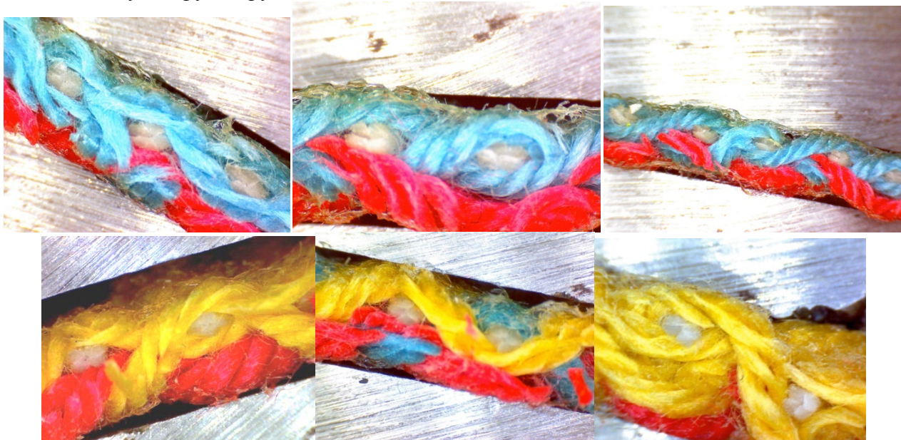
Рис.4. Разрез ткани вдоль условно нижней и верхней систем основных нитей
