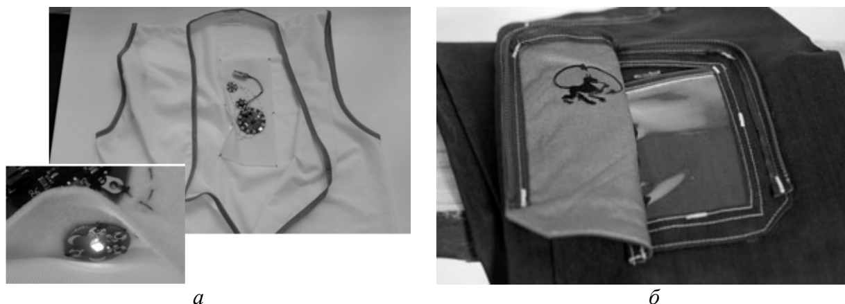
Рис.1 – Существующие образцы одежды с техническими элементами: а – топ с датчиками температуры [1]; б – джинсы от компании Alphynin Industrie с прозрачным карманом для размещения смартфона[2]
