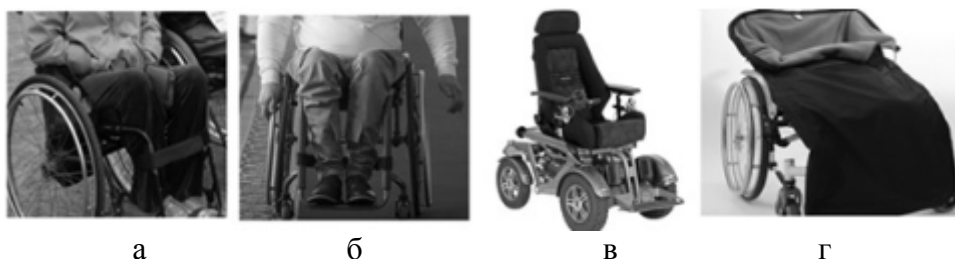
Рис.2 – Варианты закрепления положения ног в инвалидной коляске: а – ремнями спереди; б – текстильными лентами сзади [11], в – отсутствие креплений [12]; г – утепляющим чехлом [13]
