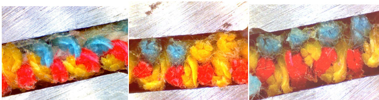
Рис.3. Разрез ткани в промежутке между уточными нитями
