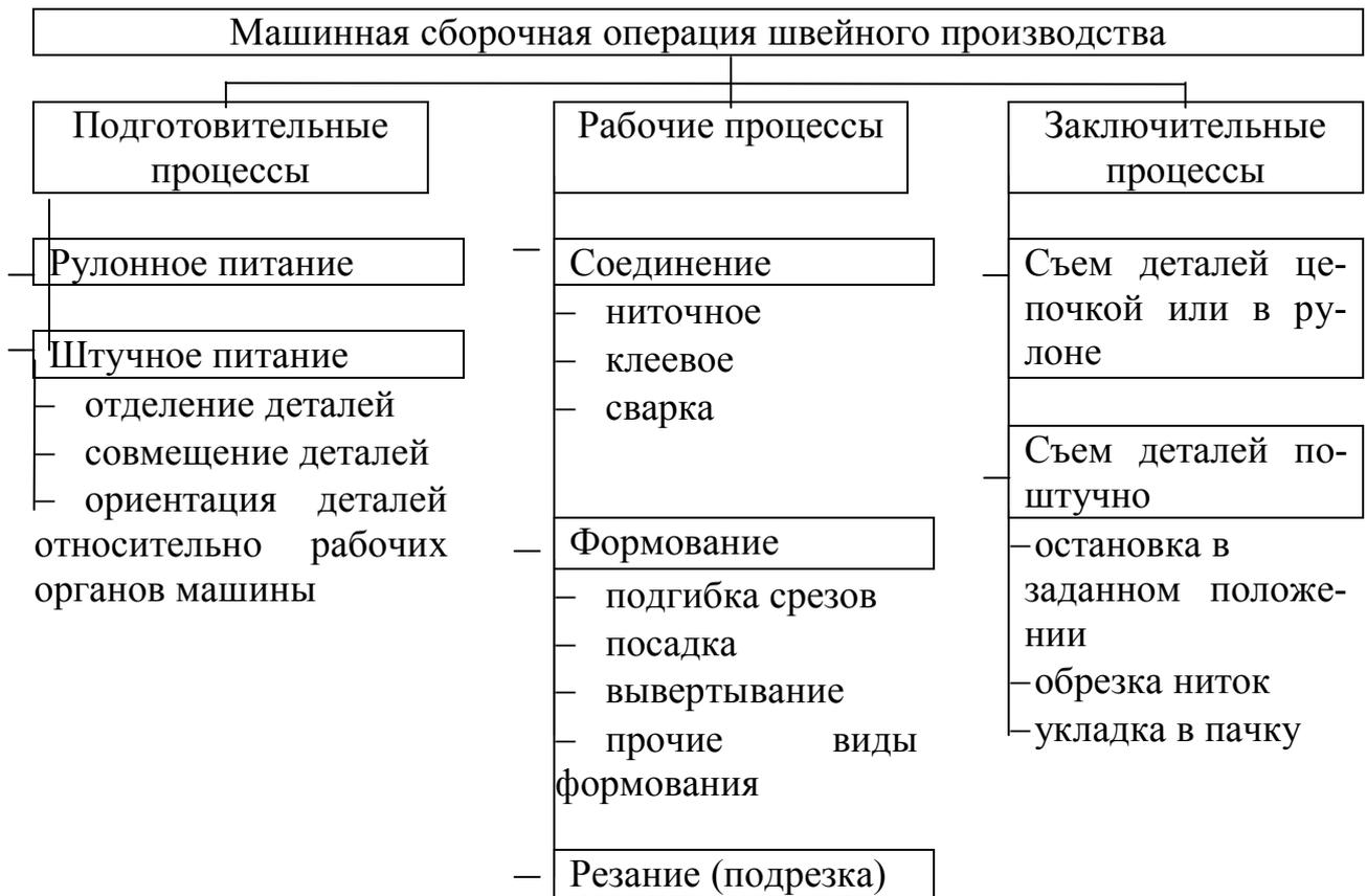
Рис. 1. Схема разделения процессов машинных сборочных операций швейного производства
