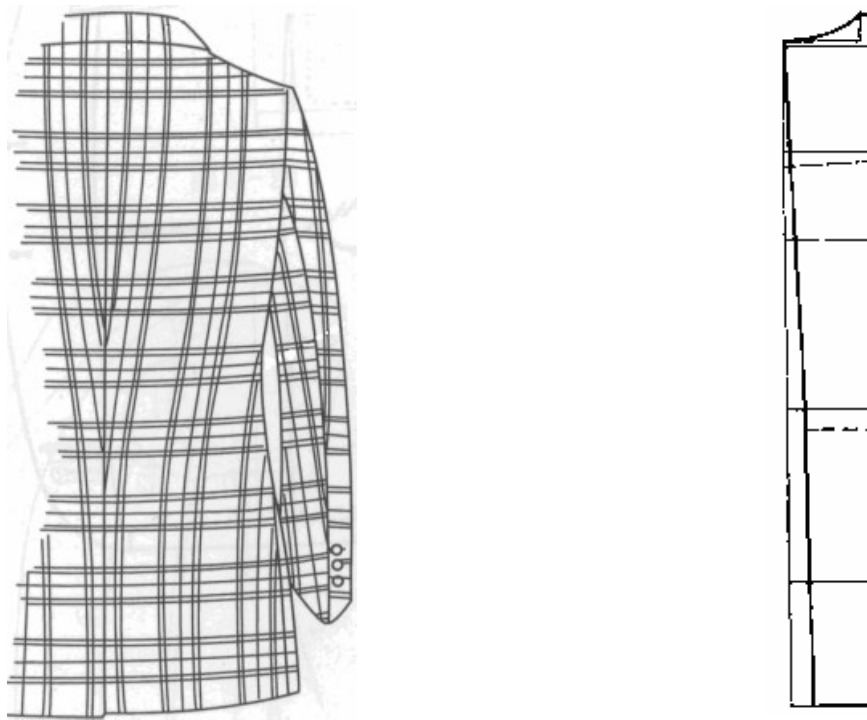
Рис.6.2. Внешний вид спинки пиджака из ткани в клетку при оформлении верхней части средней линии спинки по прямой линии
