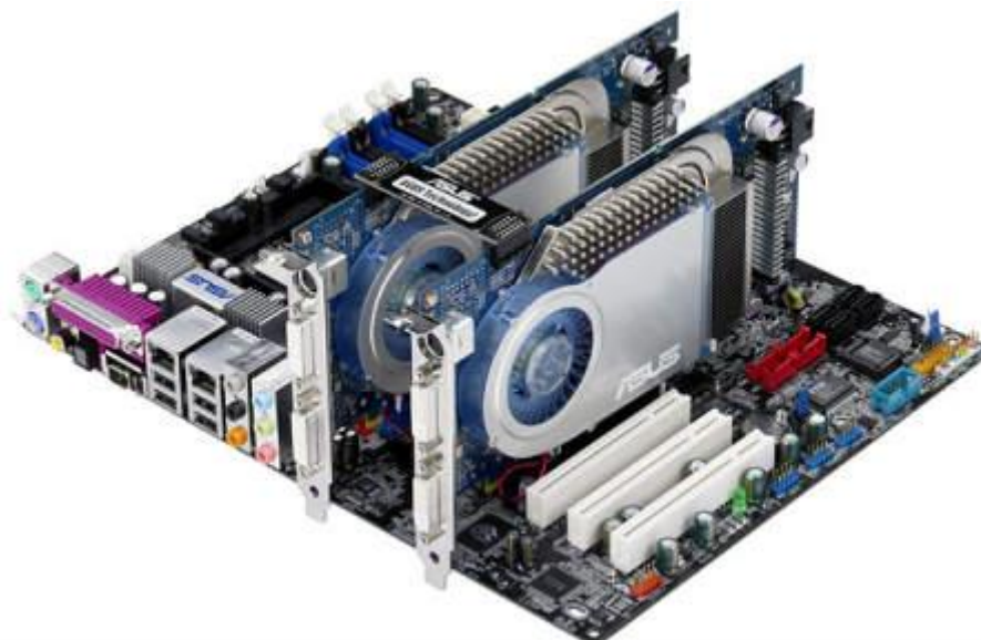
Рисунок 10 - Внешний вид системной платы ASUS A8N-SLI Delux при использовании режима SLI
