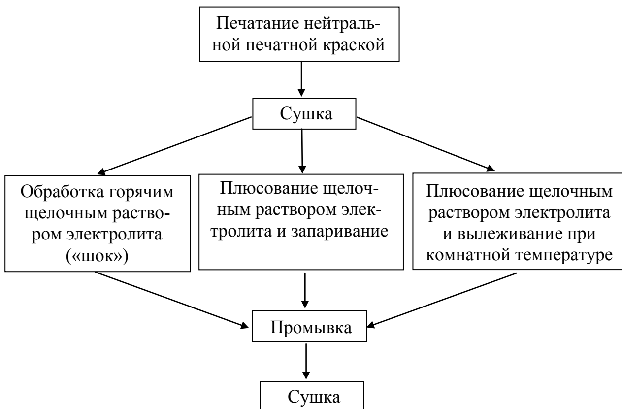
Рис.2. Схема двухстадийной печати
