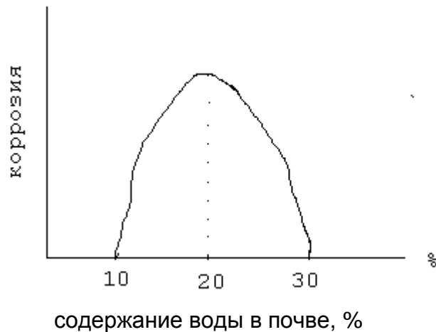
Рис. 7. Влияние содержания воды в почве на коррозию
