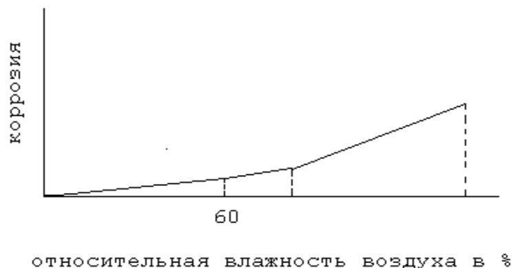
Рис. 6. Влияние влажности воздуха на коррозию стали
