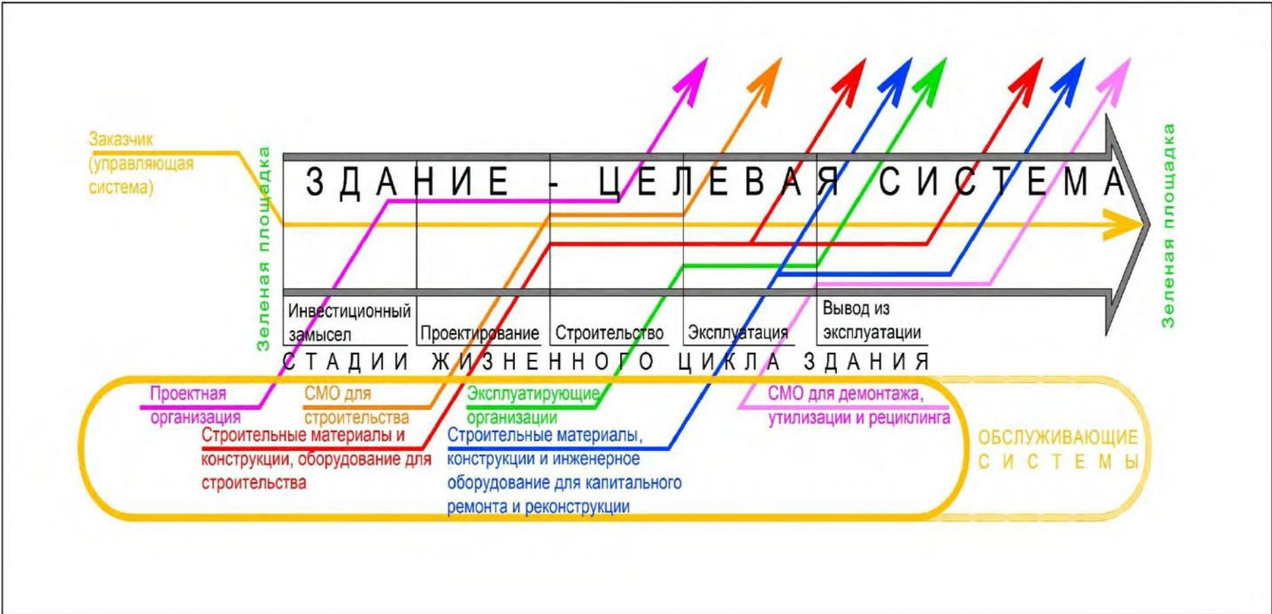
Рисунок 12 – Схема жизненного цикла здания как системы
