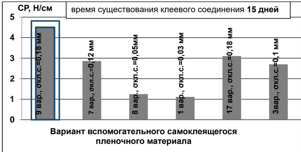
Рисунок 5.4. Влияние ингредиентного состава полимера на сопротивление расслаиванию
