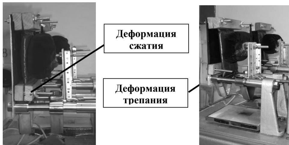
Рисунок 2.3. Фотография прибора, реализующего способ оценки миграции ППС при условиях трепания и сжатия
