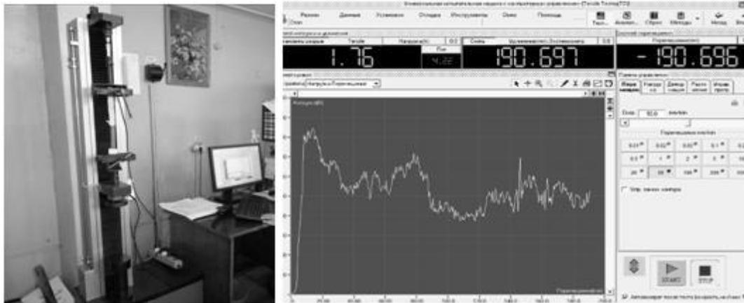
Рисунок 2.8. Фотография ИР 5081-10 с программно-техническим комплексом (ПТК) и окно программы MaxTest ShortCut
