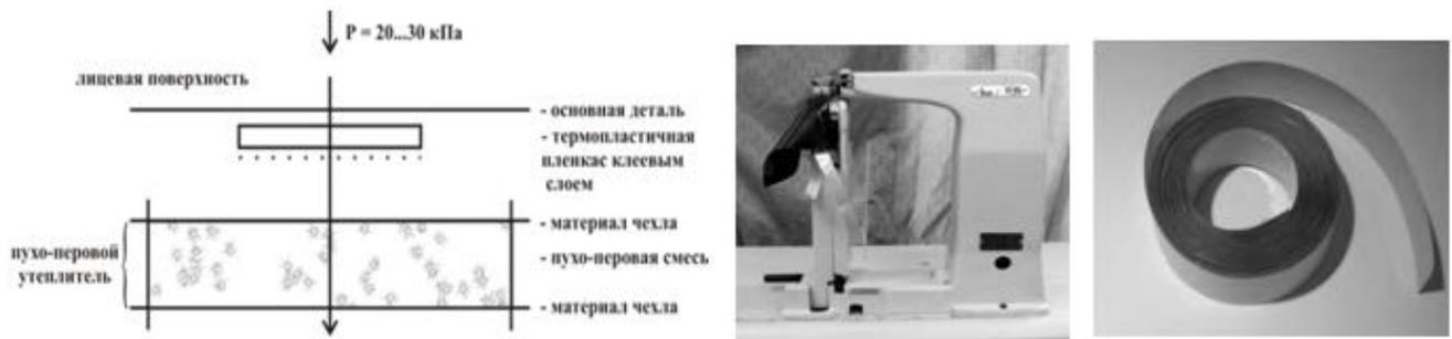
Рисунок 4.9. Условия выполнения ниточно-клеевых соединений с применением ВСПМ
