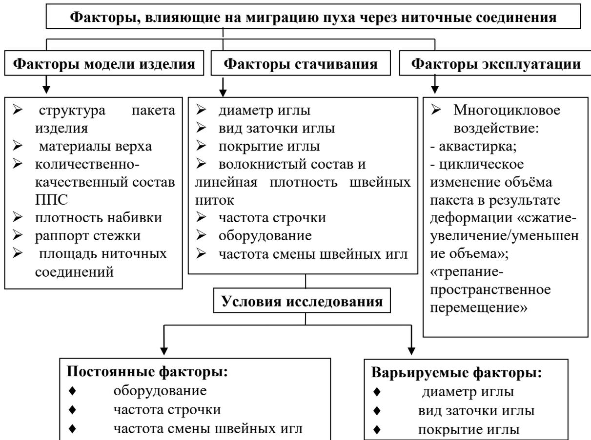
Рисунок 3.1. Классификация факторов, влияющих на миграцию ППС через ниточные соединения
