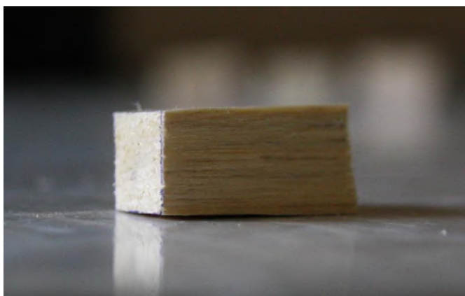
Рис. 4.6. Снимки образцов из сосны после выдержки в атмосфере растворов серной кислоты с концентрацией: а) 0 %; б) 1 %; в) 10 %; г) 50 %; д) 100 %
