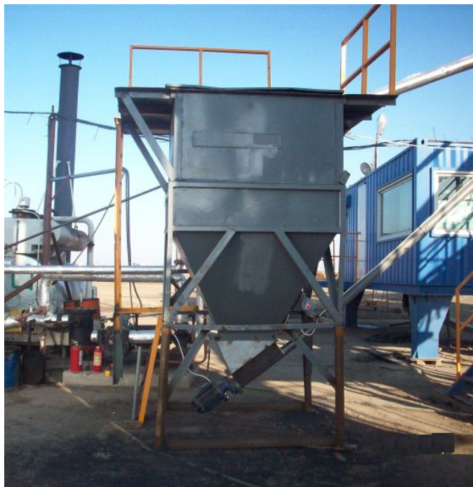
Рисунок 5.6. – Внешний вид дополнительного приемного бункера со шнековой подачей добавок
