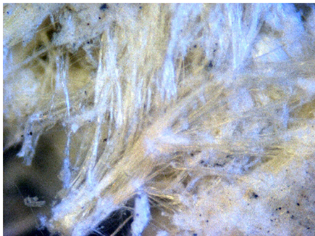
Рисунок 4.6. – Микрофотография Хризотоп увеличение X 100
