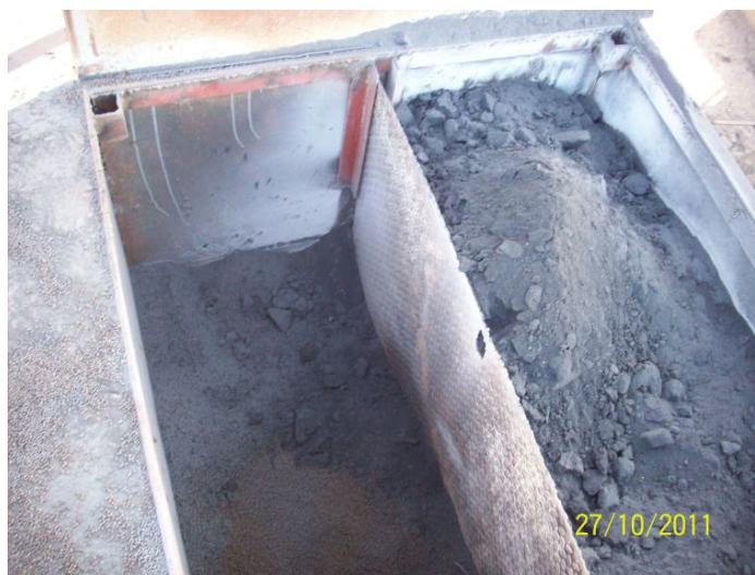
Рисунок 5.6. – Внешний вид дополнительного приемного бункера со шнековой подачей добавок
