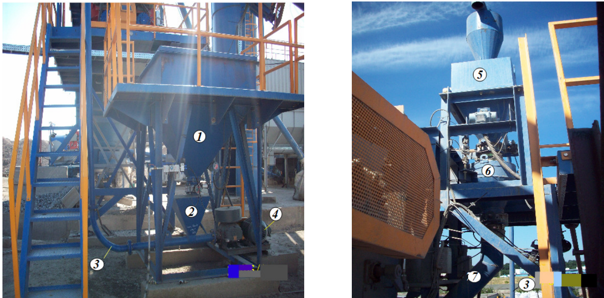
Рисунок 5.5. – Внешний вид линии дозирования и подачи гранулированных добавок для ЩМА.
